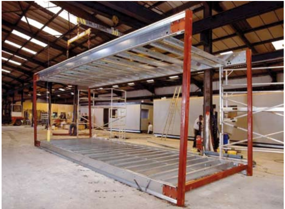
Abbildung 6.2 Modul mit Randträgern und Eckstützen Kingspan
