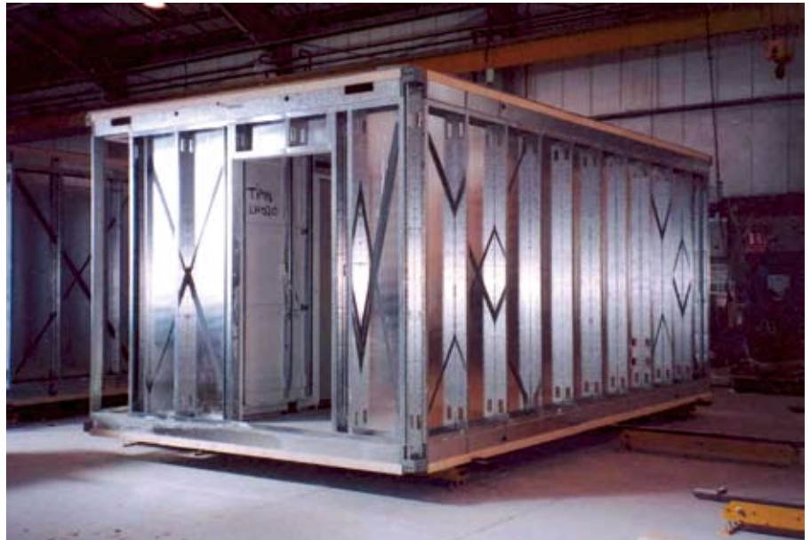
Abbildung 6.2 Modul mit tragenden Wänden Terrapin
