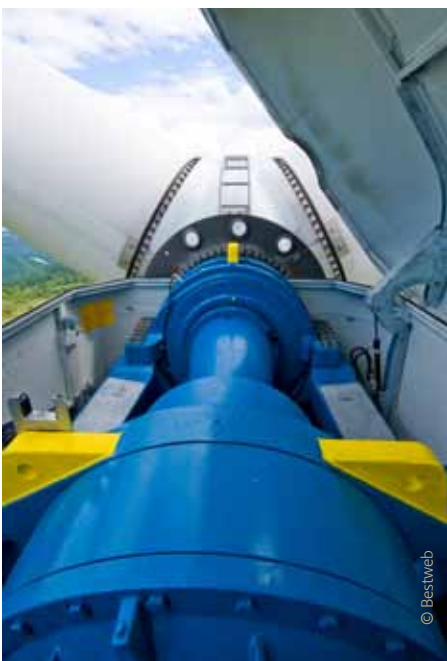
Abbildung 12: Schmiedeteile für die Antriebswelle
