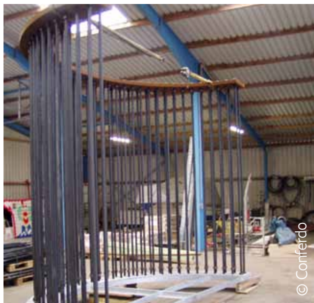
Abbildung 3: Qualitätsstabstahl für Fundamenteinbauteile
