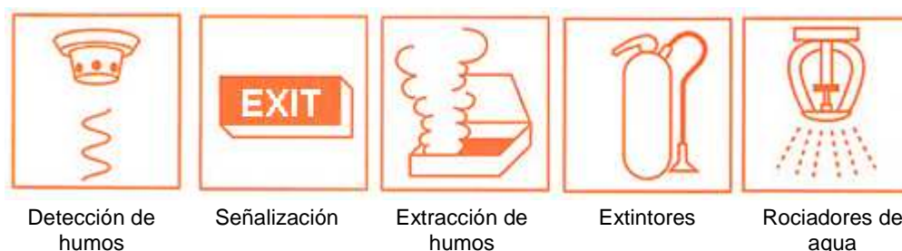
Figura 6.4 Métodos de protección activa contra el fuego
