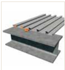
Colocación de los tapones de relleno
