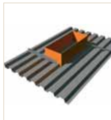
Hueco saliente utilizando encofrado de acero
