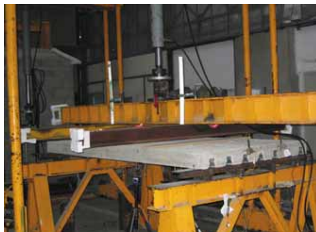
Pruebas de losas mixtas Fase de composición
