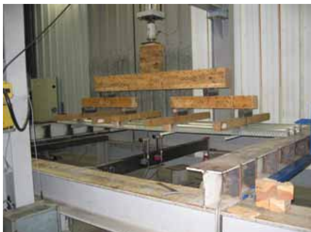
Pruebas de tableros para suelos Fase de construcción
