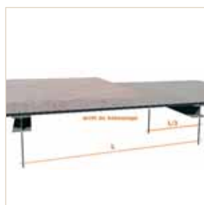
9. Ajustar la losa según avanzan los trabajos.
