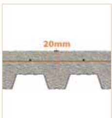
Colocación de refuerzos
