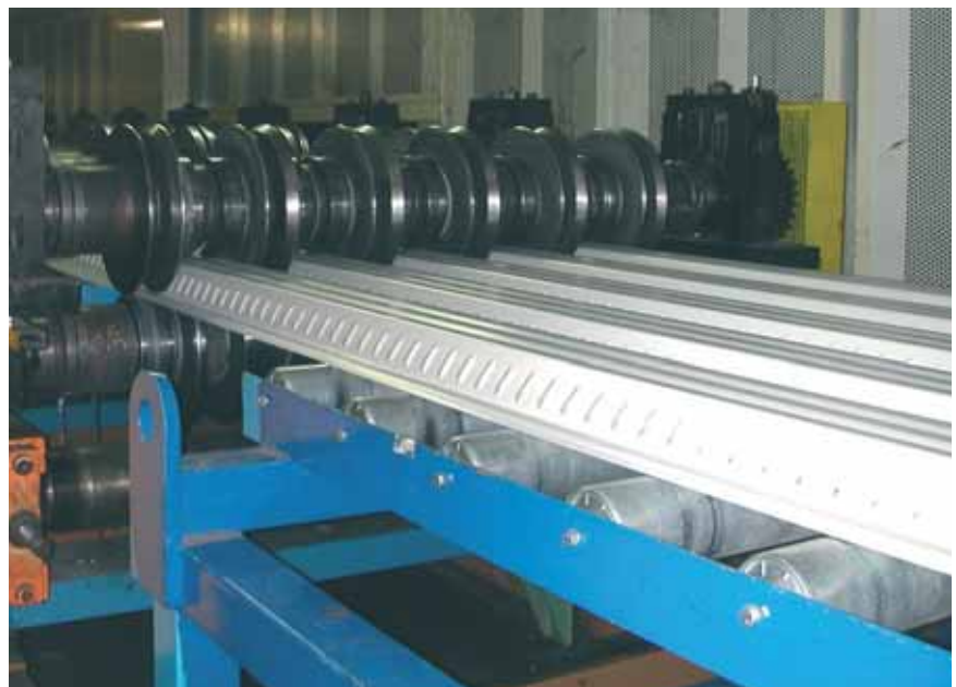
Fabricación de un tablero de forjado mixto
