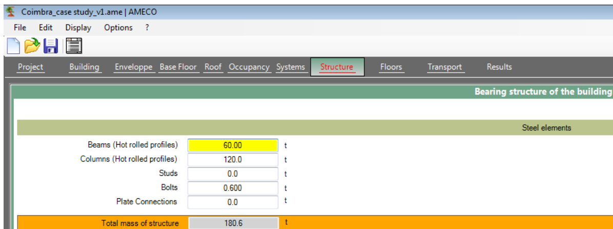
Abbildung 27: Definition der Gewichte der verschiedenen Stahlelemente
