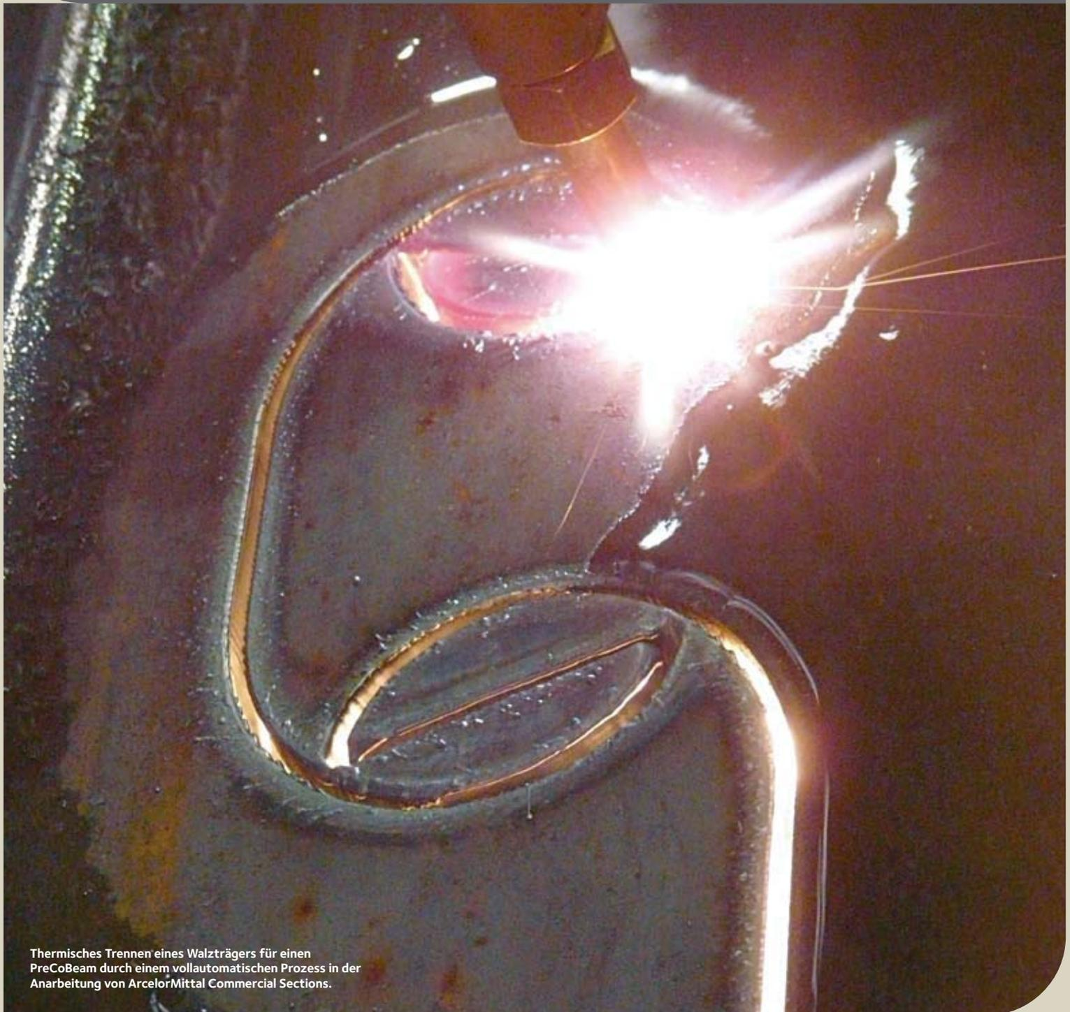
Thermisches Trennen eines Walzträgers für einen PreCoBeam durch einem vollautomatischen Prozess in der Anarbeitung von ArcelorMittal Commercial Sections.
