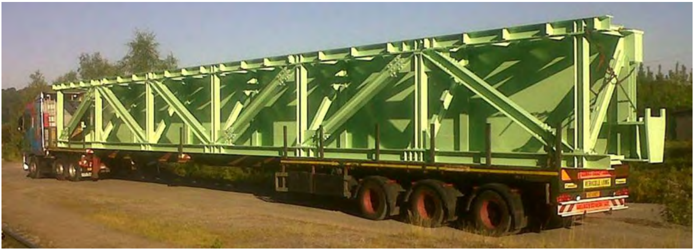
Structure de treillis pour le chemin de roulement de grue à l'aciérie de Belval, Luxembourg
