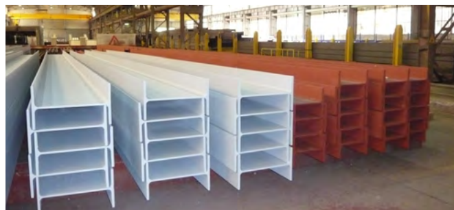
Application automatique de primer
