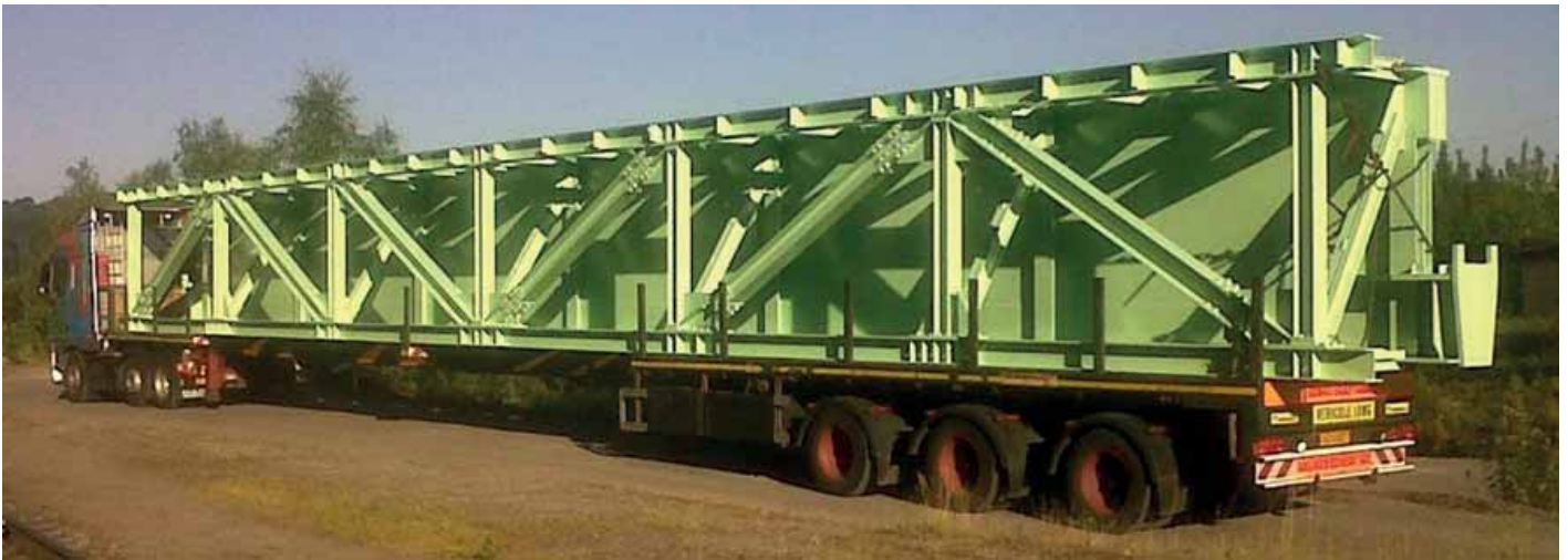
Fachwerk für die Kranbahn im Stahlwerk Belval, Luxemburg
