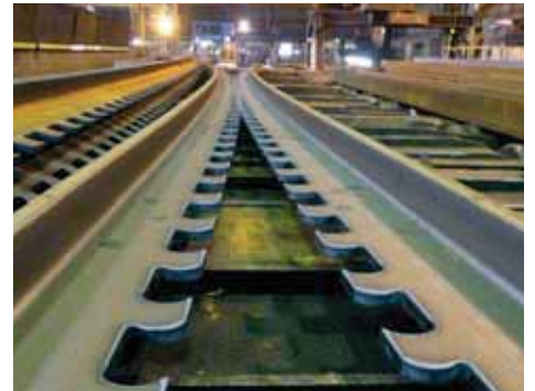
Séparation de 2 demi-poutres PreCoBeam dans les ateliers de finissage d'ArcelorMittal.
