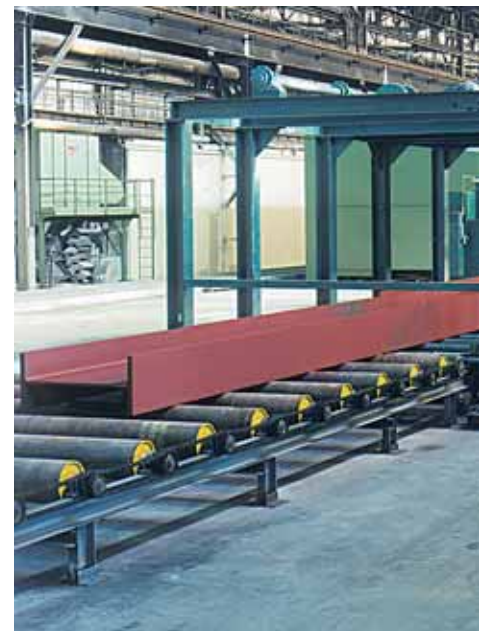
Installation de traitement de surface automatique – Grenailage et application d'une couche de peinture
