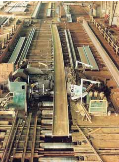
Atelier de parachèvement – Cintrage d'une poutrelle à la presse
