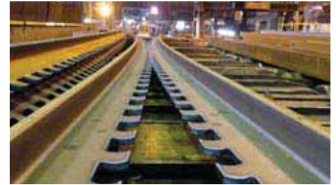
Trennen eines thermisch geschnittenen Walzträgers für eine PreCoBeam Brücke in der Anarbeitung von ArcelorMittal, Luxemburg.
