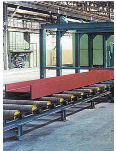
Automatische Konservierungsanlage. - Strahlen und Beschichten von Trägern.
