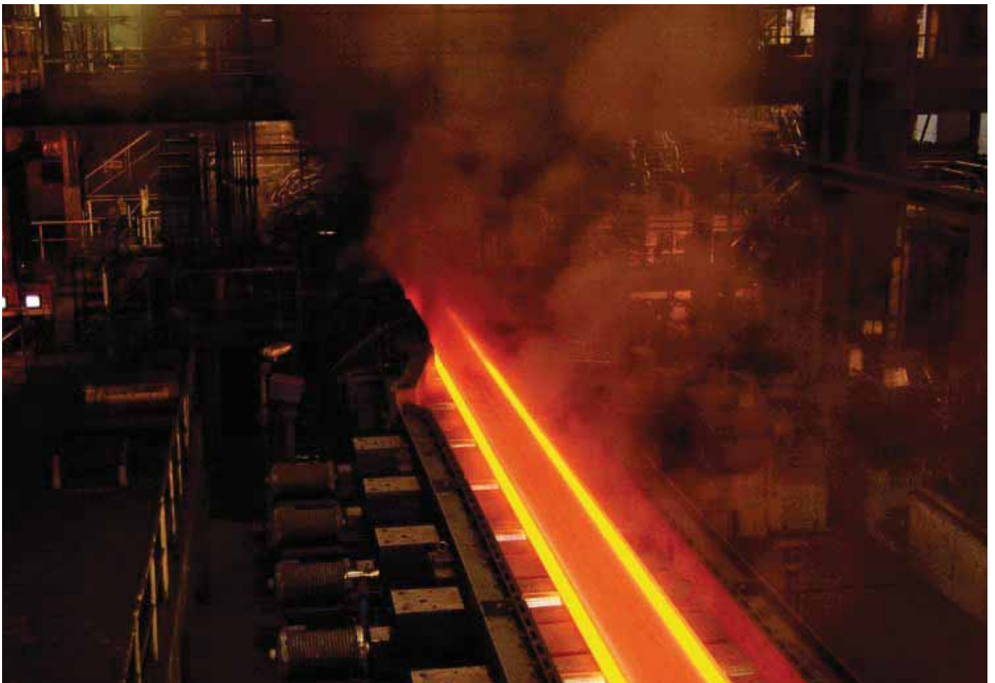
Walzung eines Trägers in HISTAR Qualität auf der Grey - Walzstraße von ArcelorMittal in Differdingen, Luxemburg
