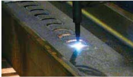
Thermisches Trennen eines Walzträgers (HD 400x421 in S460M) mit profilierter Schnittführung für einen PreCoBeam der Verbundfertigteilbrücke mit Walzträgern in Beton bei Vigaun, Österreich.
